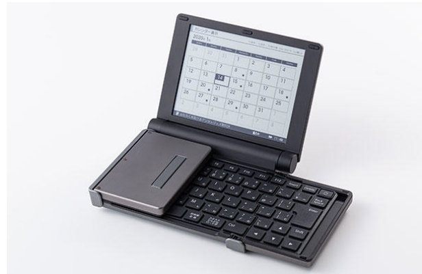
キーボードの両端は折り畳み式で、広げると大型ノートパソコンサイズのキーボードになる
