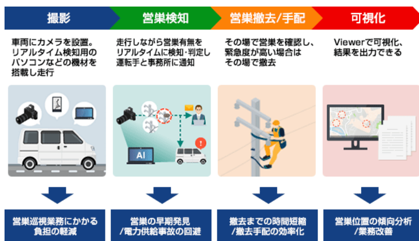
営巣検知システムのリアルタイム検知(判定)の業務フローと導入効果
